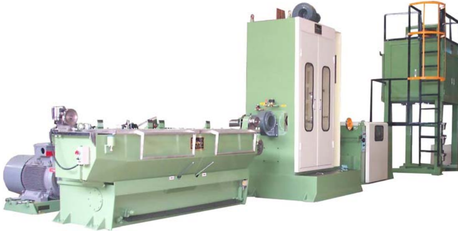
DB-17 中線伸線附連續軟化機及單軸捲取和落線架
